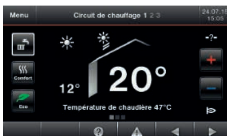
Régulation Vitotronic 200 avec écran tactile couleur Touch-Display
